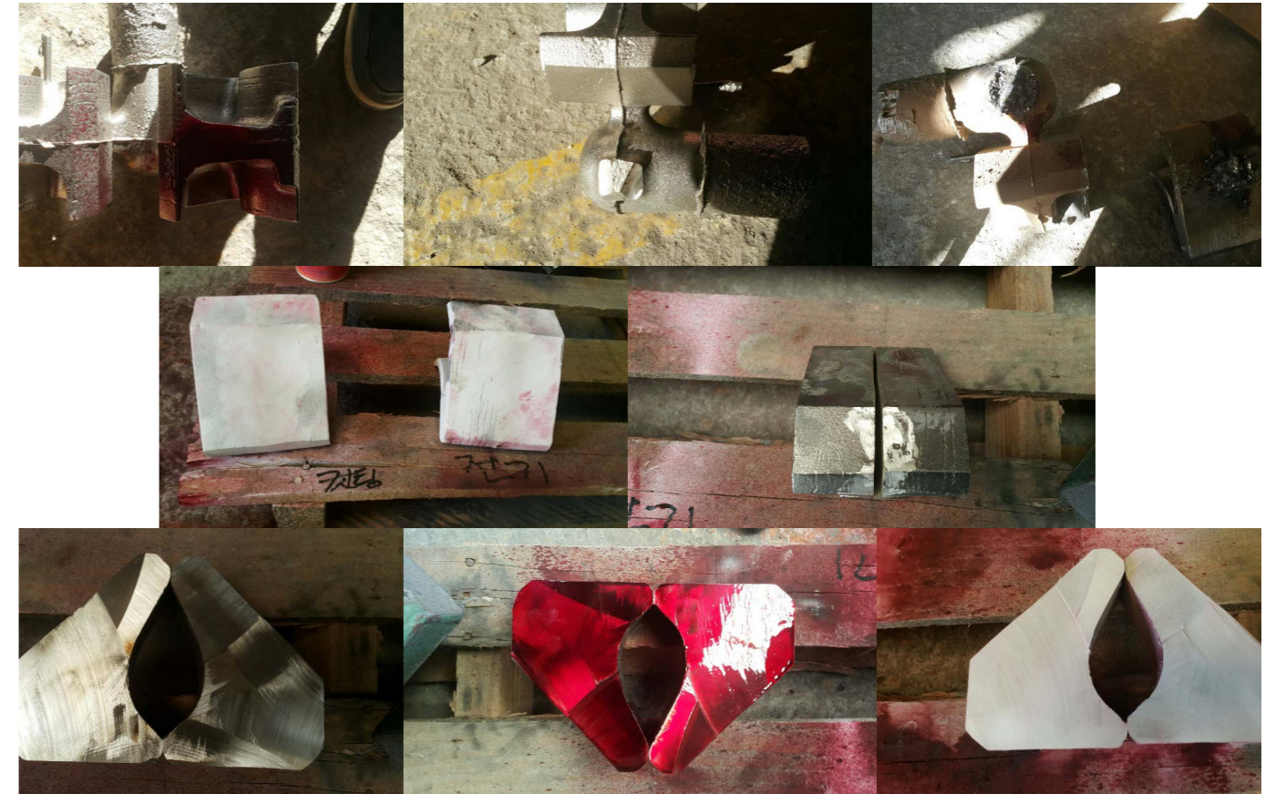
UMC050電気切断及びカッティングの切断面の検査と内部の切断面の検収写真
